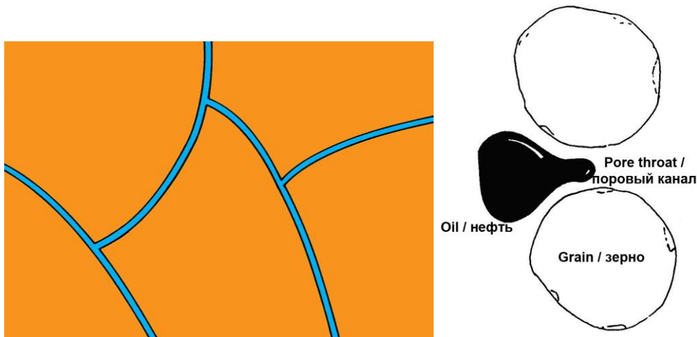
Трещиноватость и пористость
